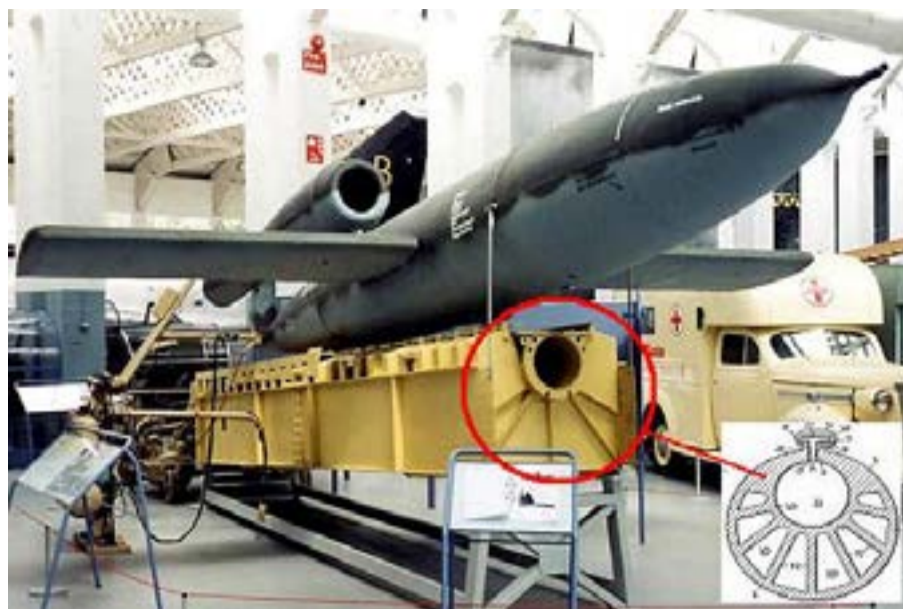
Катапульта для запуска ракеты Фау-1 системы Франца Мерца, патент 1937 г., Германия
