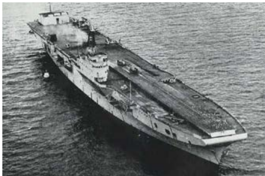
Первая паровая катапульта на борту Н.М.С. Perseus, видны тележки-нагрузатели, 1950 г.
